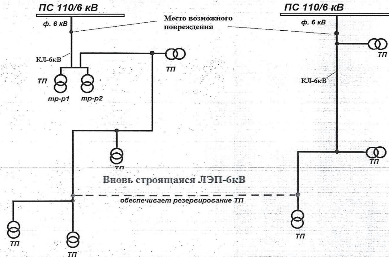
выполнить строительство линий электроснабжения уровня 6-10 кВ для резервирования питания тупиковых ТП. Это позволит снизить время отключения потребителей на время включения резервного питания с повышением категорийности присоединенных потребителей, с увеличением надежности электроснабжения потребителей, обязательным обеспечением категорийности присоединенных потребителей и впоследствии осуществить масштабную реконструкцию существующих линий 6-10 кВ.
